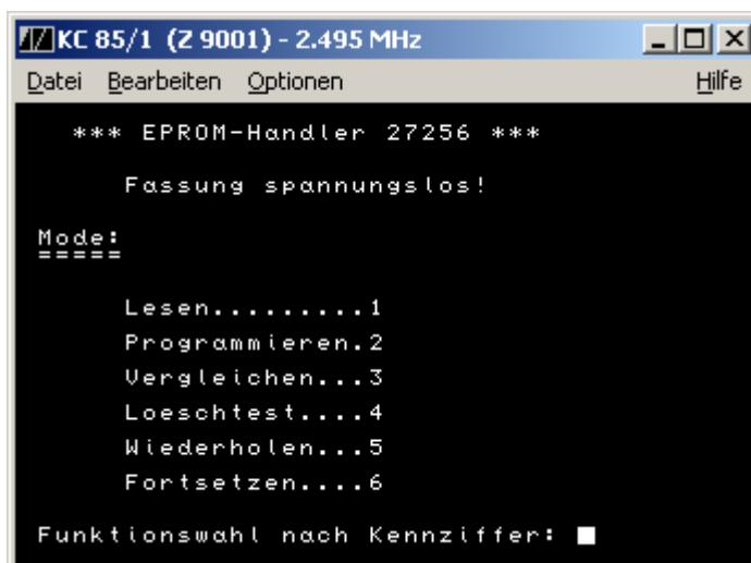
Der EPROM-HANDLER V 2.9 ist ein komfortables, menüorientiertes, für den Z 1013 entwickeltes Werkzeug. Er belegt den Adressraum von 100H bis 08FBH, wird mit J 100 gestartet und ist selbst nicht EPROM-fähig. Das im Anhang befindliche HEX-Listing gibt das Programm vollständig wieder, wobei darauf zu achten ist, dass es mit einem Adress-Offset von 1000H ausgedruckt wurde.
