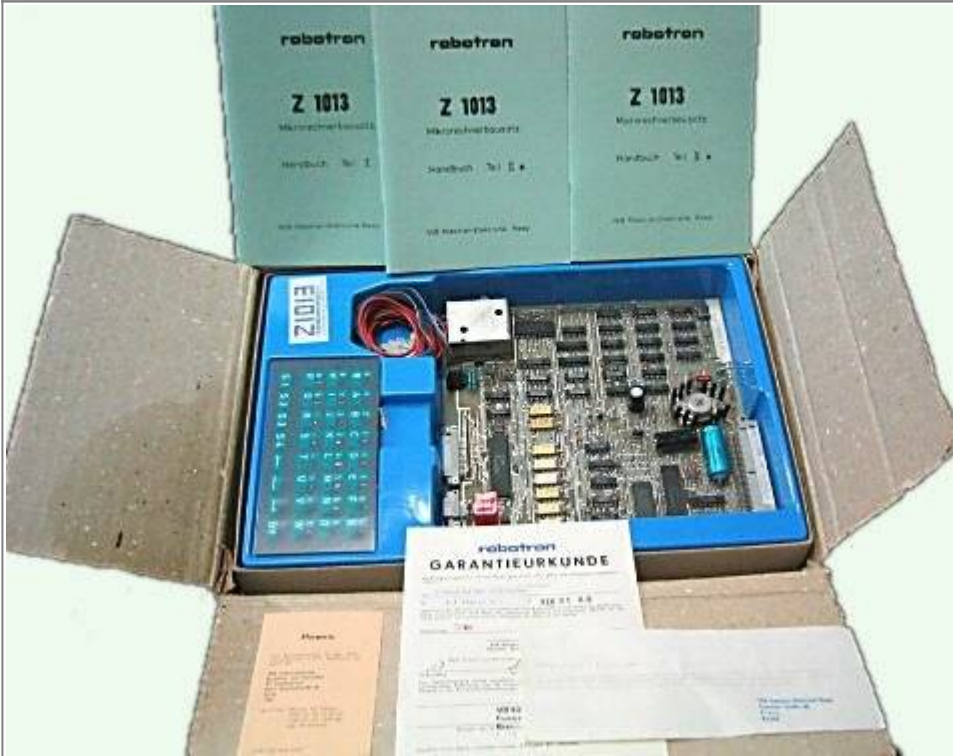
Z1013.64 in Originalverpackung mit Handbuch Teil I, Teil II a, Teil II b, Flachfolientastatur, Flachbandkabel, Steckschuhen, Garantieurkunde und Hinweisblatt
