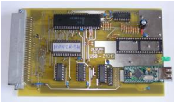
Prototyp mit VDIP1 und dem Zusatzmonitor MONER-SU inklusive Sprungverteiler
