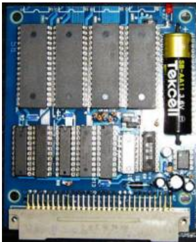
K1520-I/O Platine mit zwei Port-Adressen
