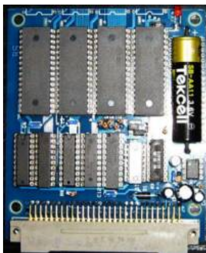
K1520-I/O Platine mit zwei Port-Adressen
