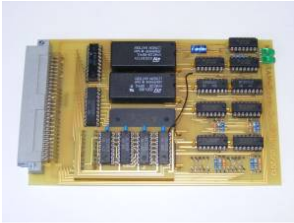
256K-RAM-Floppy, rechts 512K-RAM-Floppy mit Zeropower-RAM
