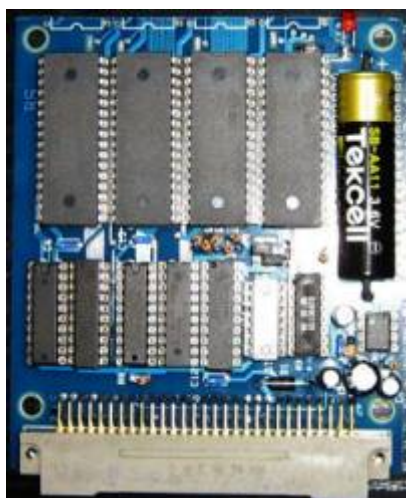
K1520-I/O Platine mit zwei Port-Adressen
