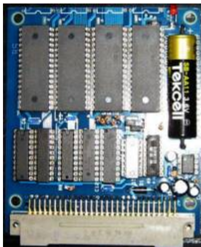
K1520-I/O Platine mit zwei Port-Adressen
