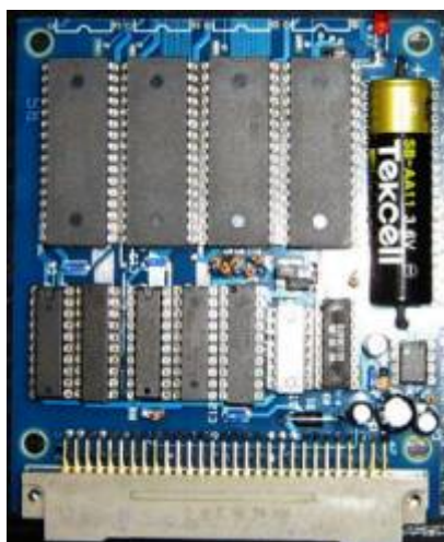
K1520-I/O Platine mit zwei Port-Adressen
