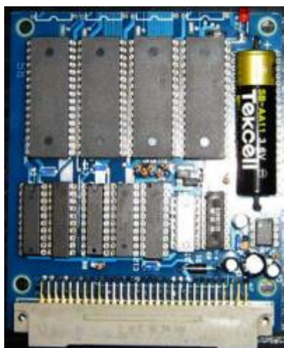
K1520-I/O Platine mit zwei Port-Adressen
