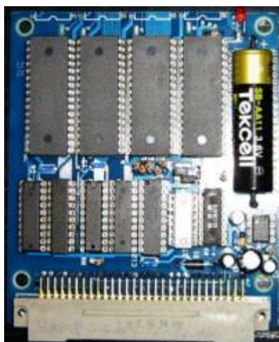
K1520-I/O Platine mit zwei Port-Adressen
