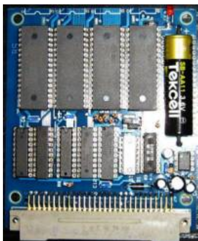
K1520-I/O Platine mit zwei Port-Adressen
