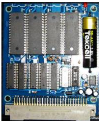
K1520-I/O Platine mit zwei Port-Adressen
