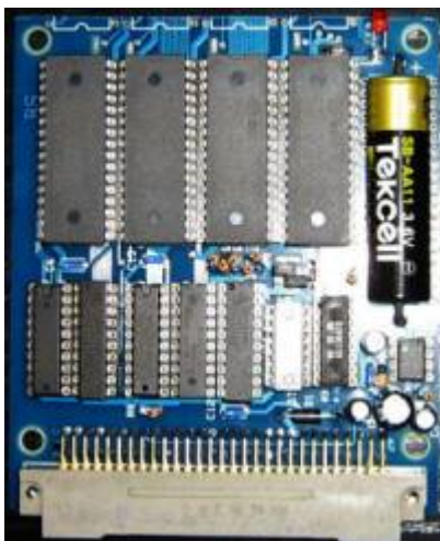
K1520-I/O Platine mit zwei Port-Adressen
