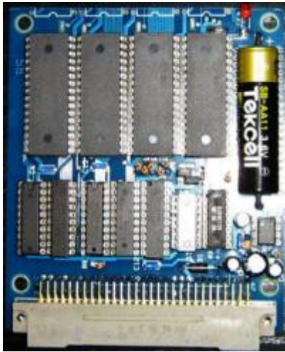
K1520-I/O Platine mit zwei Port-Adressen
