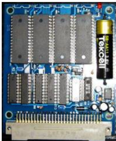
K1520-I/O Platine mit zwei Port-Adressen
