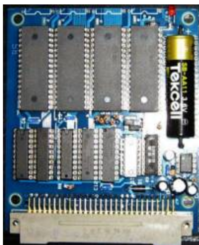
K1520-I/O Platine mit zwei Port-Adressen
