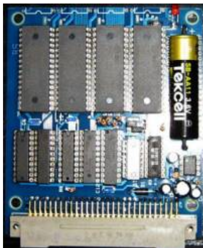
K1520-I/O Platine mit zwei Port-Adressen
