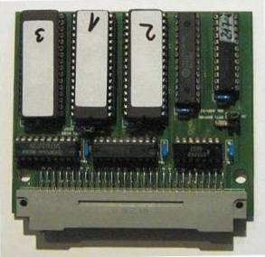
Das Mega-Modul in der Version von Honi funktioniert direkt an einem Z1013.16 und stellt gleichzeitig 32K RAM zur Verfügung, so dass Programme im Bereich 100h-BFFFh genutzt werden können!
