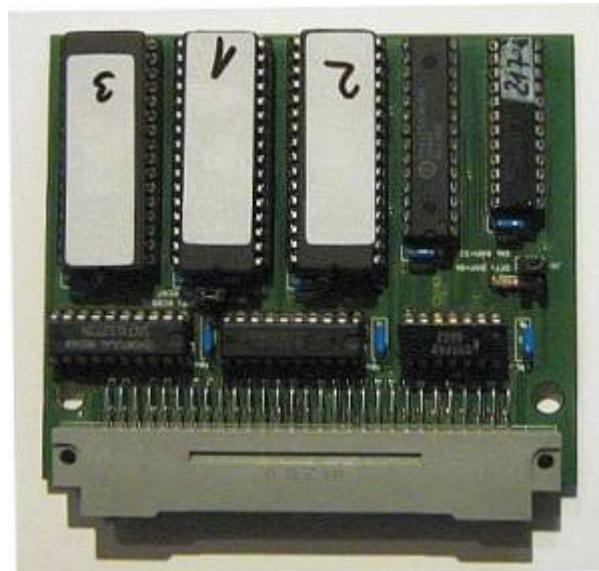
Das Mega-Modul ist ein ROM-Modul. Es wurde ursprünglich von A. Schön für den Z9001 entwickelt → [Megamodul](#). Dieses Modul kann auch am Z1013 genutzt werden, s.u. [Hardware](#). Ebenso ist das das Nachfolge-Modul [Mega-Flash-Modul](#) von Bübchen nutzbar.
