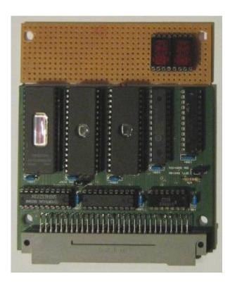
Das Mega-Modul wurde ursprünglich von A. Schön für den Z9001 entwickelt → megamodul.
