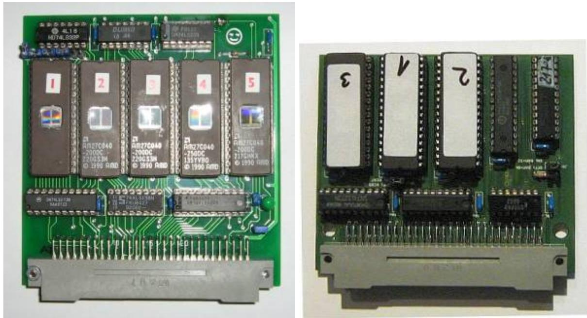
Das Mega-Modul in der Version von Honi funktioniert direkt an einem Z1013.16 und stellt gleichzeitig 32K RAM zur Verfügung, so dass Programme im Bereich 100h-BFFFh genutzt werden können!
