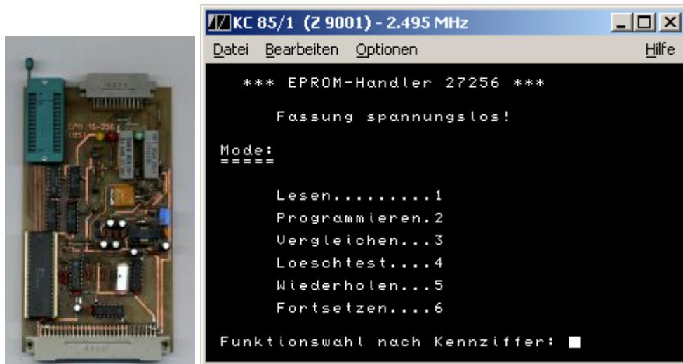
Der Z9001 und Z1013 verwenden beide denselben Modulstecker und -Bus, so dass eine Nutzung von Hardware mit beiden Geräten direkt möglich ist. Ich habe mir 1989 den oben abgebildeten Eprom-Brenner für Eproms 2716 (2K) bis 27256 (32K) gebaut und 2003 endlich auch am Z9001 nutzbar gemacht.
