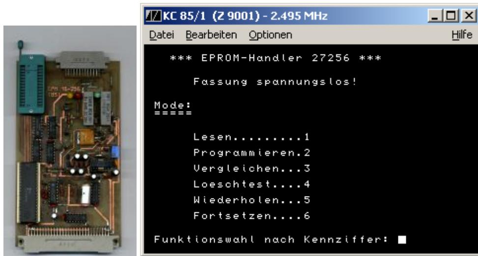
Der Z9001 und Z1013 verwenden beide denselben Modulstecker und -Bus, so dass eine Nutzung von Hardware mit beiden Geräten direkt möglich ist. Ich habe mir 1989 den oben abgebildeten Eprom-Brenner für Eproms 2716 (2K) bis 27256 (32K) gebaut und 2003 endlich auch am Z9001 nutzbar gemacht.
