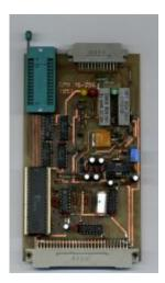
EPROM-Programmiergerät des CC Leipzig nach EPROMMER der IG-HC TU Dresden, dieser ist nach electronica Bd.227/228 eprommer-227.pdf weiterentwickelt.
