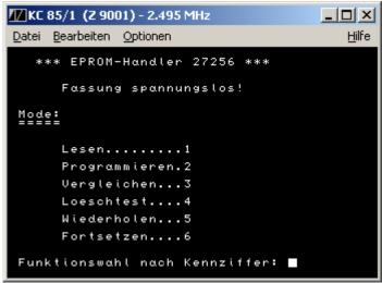
Der Z9001 und Z1013 verwenden beide denselben Modulstecker und -Bus, so dass eine Nutzung von Hardware mit beiden Geräten direkt möglich ist. Ich habe mir 1989 den oben abgebildeten Eprom-Brenner für Eproms 2716 (2K) bis 27256 (32K) gebaut und 2003 endlich auch am Z9001 nutzbar gemacht. Dazu habe ich die Software des Z1013 von Rainer Brosig disassembliert und auf den Z9001 umgesetzt.
