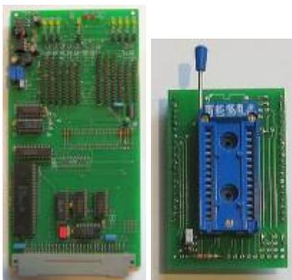
Der EPROM steckt auf einen extra Adapter. Dieser wird je nach Typ auf der Hauptplatine aufgesteckt.
