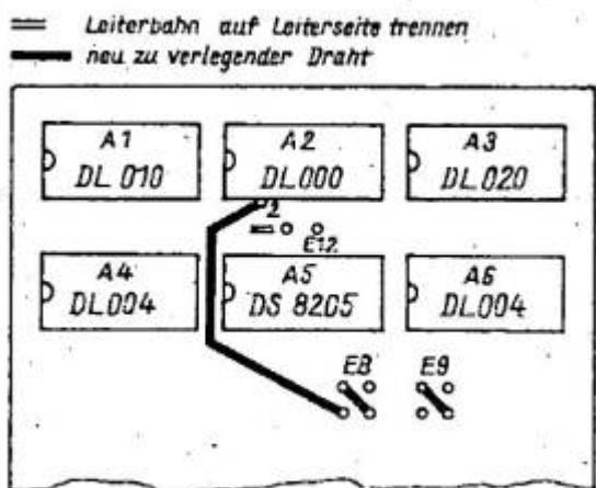
Die Brücken E8 und E9 gestatten es, die Speicherausblendung für den Bereich von 4000H bis FFFF aufzuheben. Der Bildwiederholspeicher und der EPROM bleibt auch dann ausgeblendet.
