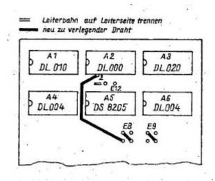
Die Brücken E8 und E9 gestatten es, die Speicherausblendung für den Bereich von 4000H bis FFFF aufzuheben. Der Bildwiederholspeicher und der EPROM bleibt auch dann ausgeblendet.
