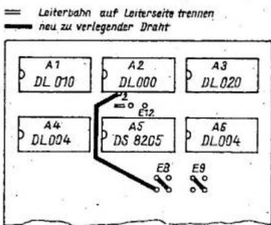
Die Brücken E8 und E9 gestatten es, die Speicherausblendung für den Bereich von 4000H bis FFFF aufzuheben. Der Bildwiederholspeicher und der EPROM bleibt auch dann ausgeblendet. Gegenüber der Schaltung trennt die Brücke E8 jedoch auch den Anschluß 2 von A2 von der Adresse 14 ab. Viele Amateure haben ihre Grundplatte auf 64 KByte erweitert und möchten diesen Speicher auch weiterhin ohne den Zukauf der recht teuren RAM-Module des KC 85/1 (KC 87) nutzen.
