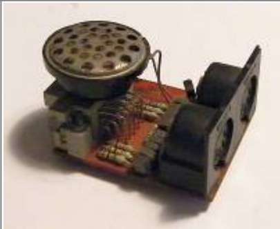
Joystick-Anschluss für 2 Joysticks nach practic und Lautsprecher für Sound
