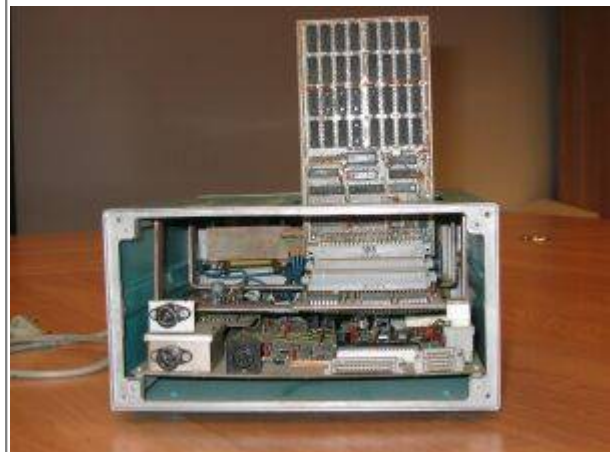
Ansicht von vorn. Zu sehen ist links der zusätzliche Videoausgang und rechts der Baugruppenträger, auf U-Winkel geschraubt.
