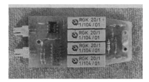
Für den Mikrorechner-Bausatz Z 1013 wurde ein Zusatz entwickelt, der es gestattet, die Kapazität von Kondensatoren und anderen Bauelementen ab etwa 10 pF aufwärts zu bestimmen.<sup>1)</sup>
