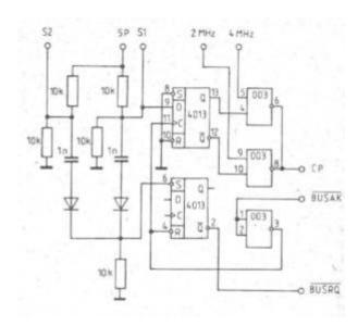
Grundgedanke der Schaltung ist es (**Bild 5**), die Umschaltung der Frequenz während des Tristatezustandes der CPU durchzuführen. Die Betätigung des Schalters S setzt das RS-Flip-Flop (V 4013).
