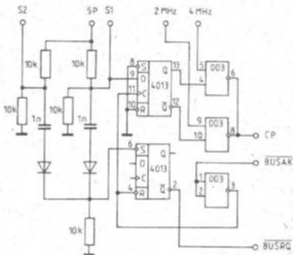
Grundgedanke der Schaltung ist es (**Bild 5**), die Umschaltung der Frequenz während des Tristatezustandes der CPU durchzuführen. Die Betätigung des Schalters S setzt das RS-Flip-Flop (V 4013).
