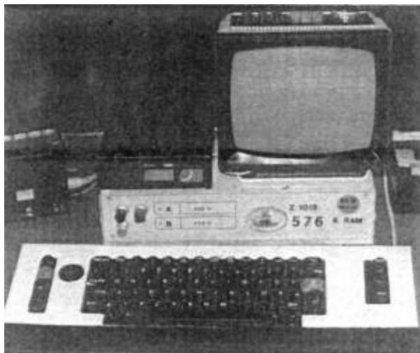
Der Mikrorechnerbausatz Z 1013 hat in unserer Republik eine große Verbreitung gefunden. Die Offenlegung aller Unterlagen durch den Hersteller und die großzügige Auslegung der Bedingungen für Reparaturen haben zu einer Vielzahl von Um- und Ausbauten sowie zu vielen guten Programmen geführt. Was ist mit dem Z 1013 heutzutage machbar?
