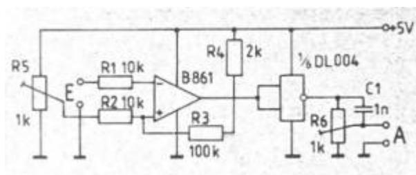
Ein Operationsverstärker arbeitet als Schwellwertschalter (**Bild 10**). Mit dem Regler R5 wird die untere Empfindlichkeitsgrenze eingestellt. Störgeräusche, wie das Rauschen vom Tonband, können damit ausgeblendet werden.
