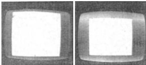
In **Bild 6** ist die beschriebene Bildschirmfläche mit Originalröhre und in **Bild 7** mit einer 110°-Bildröhre zu sehen.
