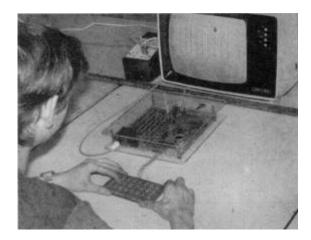
Die fehlende akustische Rückkopplung beim Betätigen der Tastatur des Z 1013 zwingt den Bediener zu einem ständigen Blickwechsel zwischen Tastatur und Bildschirm.
