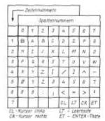
Bild 2: Matrix für die aus Halltasten aufgebaute Tastatur für den "Z 1013"
