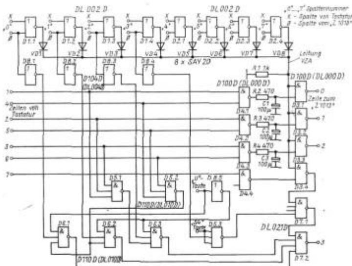
**Bild1: Stromlaufplan der Tastatur für den Mikrorechnerbausatz „Z 1013“**
