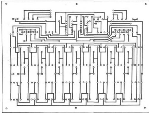
Bild 2: Leiterseite für die Tastatur-Leiterplatte
