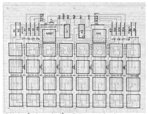
Bild 3: Bestückungsplan für die Tastatur-Leiterplatte
