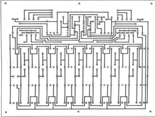
Bild 2: Leiterseite für die Tastatur-Leiterplatte
