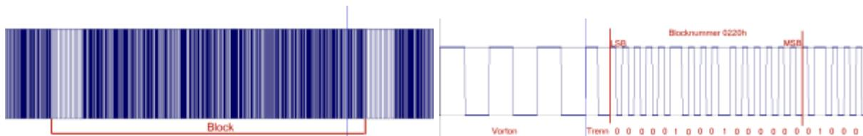
Es werden immer vollständige Blöcke aufgezeichnet, auch wenn die angegebene Endadresse in der Mitte eines Blocks liegt. Zwischen zwei Blöcken, d.h. zwischen dem letzten Phasenwechsel der Prüfsumme und dem ersten Phasenwechsel des Vortons, gibt es eine etwa 2,5 ms lange Pause.
