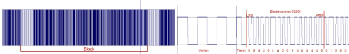
Es werden immer vollständige Blöcke aufgezeichnet, auch wenn die angegeben Endadresse in der Mitte eines Blocks liegt. Zwischen zwei Blöcken, d.h. zwischen dem letzten Phasenwechsel der Prüfsumme und dem ersten Phasenwechsel des Vortons, gibt es eine etwa 2,5 ms lange Pause.
