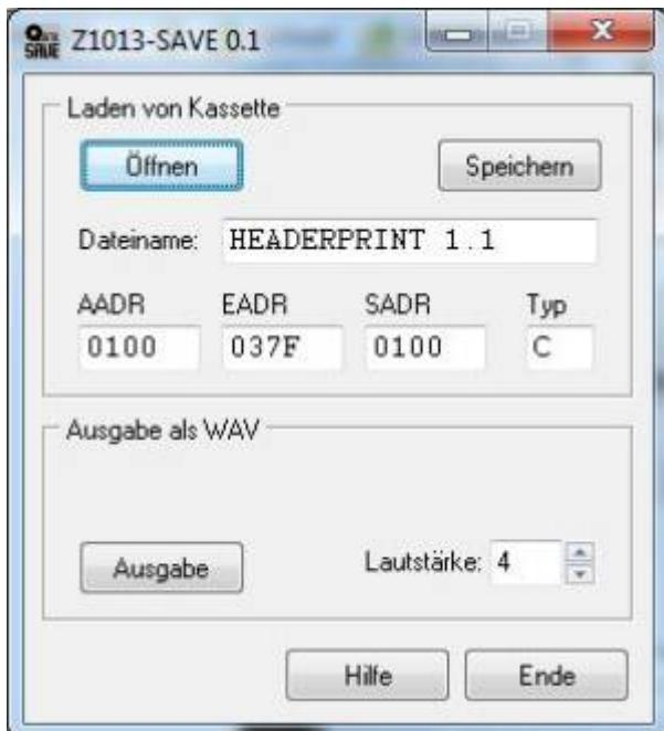
Zum Ausgeben von .Z80-Headersave-Dateien auf den Z1013 müssen die Binärdaten wieder in Audiosignale zurückverwandelt werden. Im obigen KCLOAD funktioniert bei mir unter Windows 7 die Audio-Ausgabe gar nicht mehr; unter Windows 98 funktioniert die Audioausgabe, allerdings gibt KCLOAD keinen Headersave-Vorblock aus. Deshalb gibt es ein kleines 32-Bit-Programm **ZSAVE** von mir. Über Speichern kann das Audiosignal als WAV-Datei gespeichert werden.
