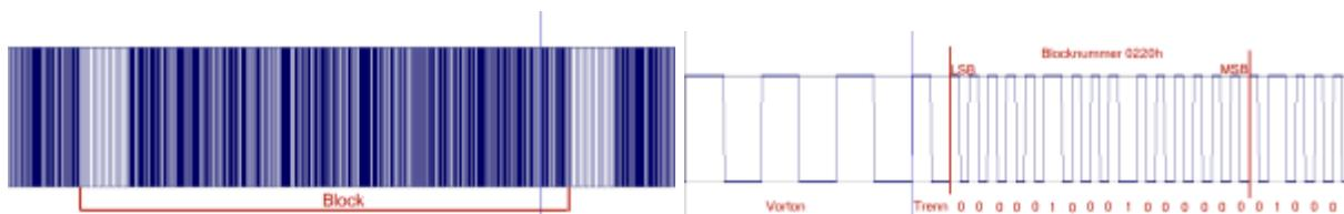
Es werden immer vollständige Blöcke aufgezeichnet, auch wenn die angegebenen Endadresse in der Mitte eines Blocks liegt. Zwischen zwei Blöcken, d.h. zwischen dem letzten Phasenwechsel der Prüfsumme und dem ersten Phasenwechsel des Vortons, gibt es eine etwa 2.5 ms lange Pause.
