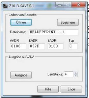
Zum Ausgeben von .Z80-Headersave-Dateien auf den Z1013 müssen die Binärdaten wieder in Audiosignale zurückverwandelt werden. Im obigen KCLOAD funktioniert bei mir unter Windows7 die Audio-Ausgabe gar nicht mehr; und unter Windos898 wird kein Headersave-Vorblock ausgegeben. Deshalb gibt es ein kleines 32Bit-Programm von mir. Über Speichern kann das Audiosignal als WAV-Datei gespeichert werden.
