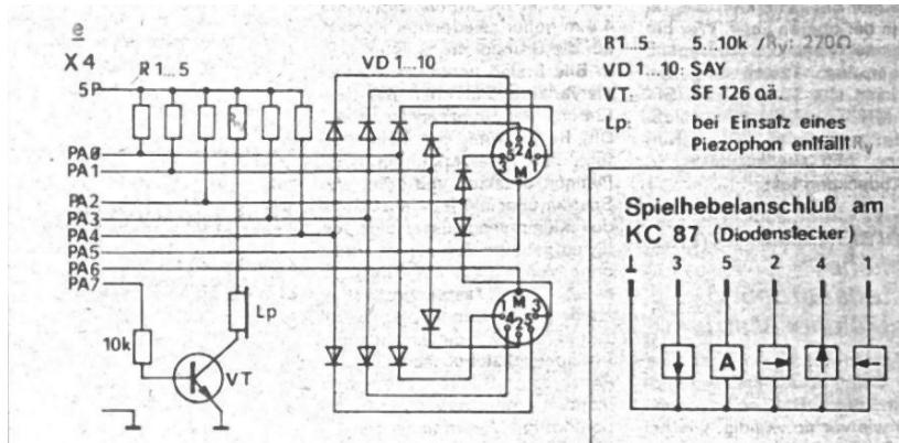
Letztere Schaltung hat den Vorteil, dass die industriell gefertigten [Spielhebel des Z9001/KC87](#) angeschlossen werden konnten. Zusätzlich ist der Code zur Abfrage dieses Anschlusses im bekannten [Brosig-Monitor](#) enthalten und kann per [Sprungverteiler](#) aufgerufen werden.
