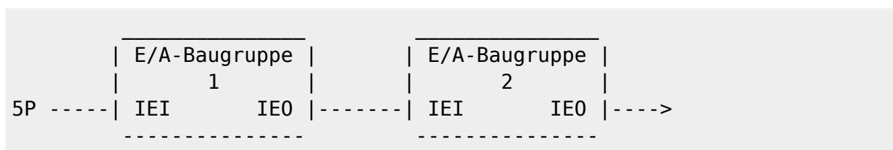
Die in einer solchen Kaskade am weitesten links stehende Baugruppe hat den groessten Vorrang. Wird an dieser E/A-Einheit eine Unterbrechung angemeldet, dann wird diese Kette unterbrochen (der Schalter oeffnet), so dass fuer die nachfolgenden Einheiten ein Interrupt gesperrt ist.
