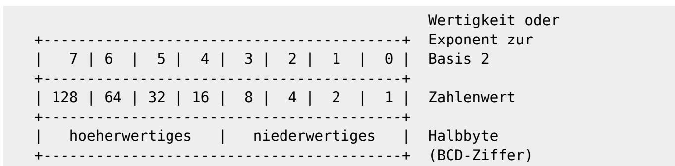
Die in der Bytedarstellung eingetragenen Ziffern geben die Numerierung der einzelnen Bit's an. Das Bit 0 besitzt die niedrigste Wertigkeit, das Bit 7 die hoechste.
