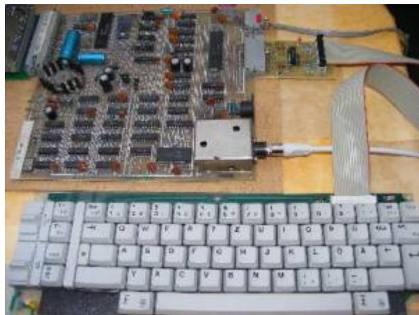
Um eine K 7669 (Tastatur der Schreibmaschine Erika S 3004) anzuschließen, ist ein geänderter A2-Monitor nötig. s. <http://www.robotrontechnik.de/html/forum/thwb/showtopic.php?threadid=8757>
