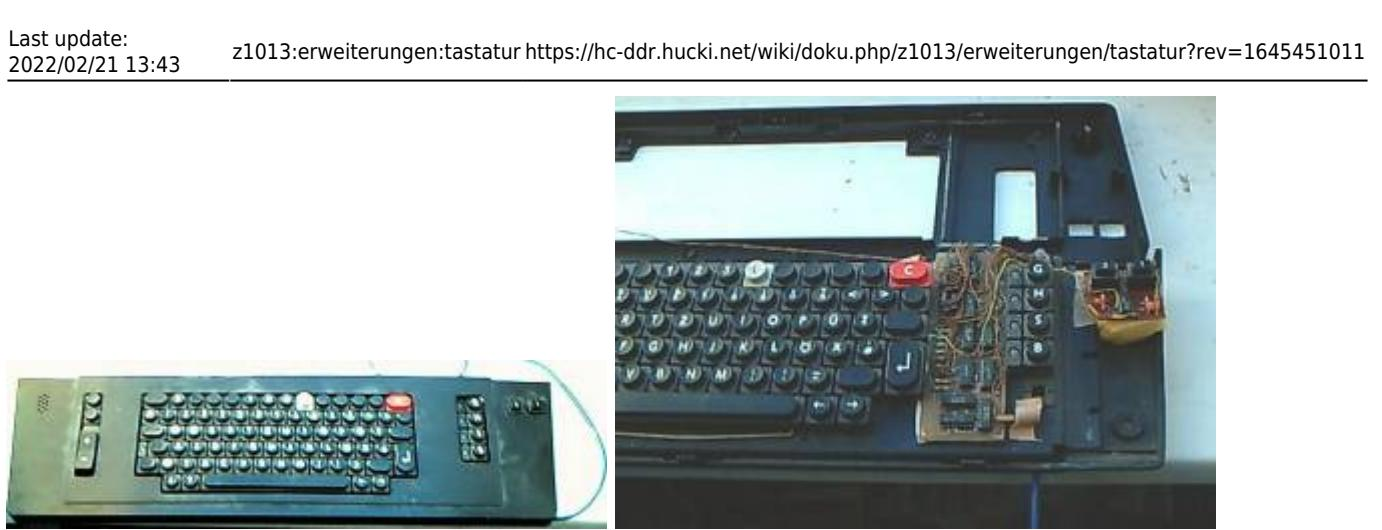
Die Leiterplatte wurde so entworfen, dass sie auf einer K7659-Tastatur rechts zwischen Enter und Sondertasten passt.
