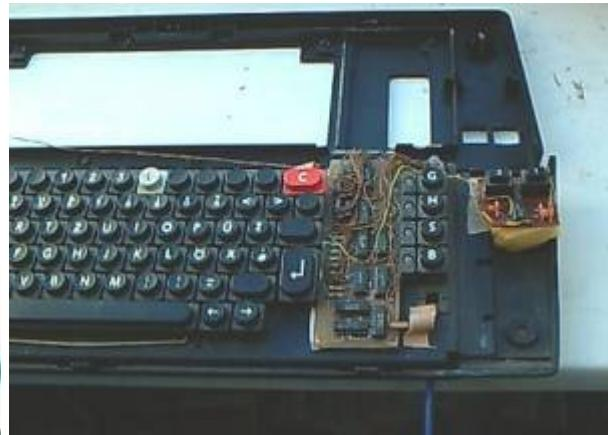
Die Leiterplatte wurde so entworfen, dass sie auf einer K7659-Tastatur rechts zwischen Enter und Sondertasten passt.
