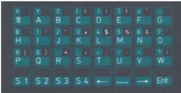
Originale Flachfolientastatur des Z1013. Die Anordnung der Tasten in alphabetischer Reihenfolge, die 5fach-Belegung mit Shift1..Shift4 und der nötige hohe Druck auf die Tasten, um einen Kontakt herzustellen, machen das Arbeiten mit dieser Tastatur zur Qual.
