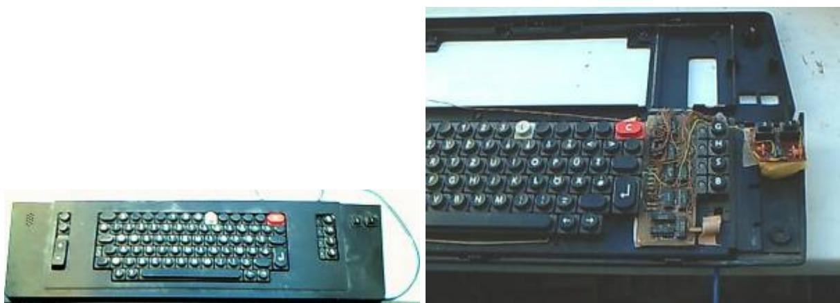
Die Leiterplatte wurde so entworfen, dass sie auf einer K7659-Tastatur rechts zwischen Enter und Sondertasten passt.
