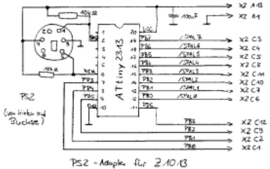
Von [Uwe Gubsch](#) stammt eine einfache Lösung zum Anschluss einer PS/2-Tastatur mit nur einem IC ATINY2313. Emuliert werden die Tasten der originalen Flachfolientastatur; damit kann diese Lösung ohne Änderung an einem originalen Z1013 betrieben werden!
