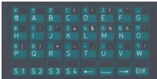
Originale Flachfolientastatur des Z1013. Die Anordnung der Tasten in alphabetischer Reihenfolge, die 5fach-Belegung mit Shift1..Shift4 und der nötige hohe Druck auf die Tasten, um einen Kontakt herzustellen, machen das Arbeiten mit dieser Tastatur zur Qual.
