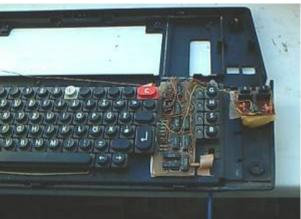
Die Leiterplatte wurde so entworfen, dass sie auf einer K7659-Tastatur rechts zwischen Enter under Sondertasten passt.
