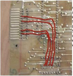
Damit 12 Spalten abgefragt werden koennen, muss die 4-bit Spalteninformation neu decodiert werden, da der originale Spaltendecoder nur bis 10 decodiert. Dazu ist es erforderlich, dass die 4-bit-Spalteninformation vom Spaltenlatch A47 ueber die vier freien Kontakte auf dem Loetkamm des Tastaturanschlusses gefuehrt wird. Sollten auch diese vier Draehte zu viel Aenderung auf der Platine darstellen, so kann der Spaltenlatch auch extern ueber den Systemstecker neu ausdecodiert werden.
