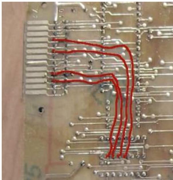
Damit 12 Spalten abgefragt werden können, muss die 4-bit Spalteninformation neu decodiert werden, da der originale Spaltendecoder nur bis 10 decodiert. Dazu ist es erforderlich, dass die 4-bit-Spalteninformation vom Spaltenlatch A47 über die vier freien Kontakte auf dem Leiterkamm des Tastaturanschlusses geführt wird. Sollten auch diese vier Drähte zu viel Aenderung auf der Platine darstellen, so kann der Spaltenlatch auch extern über den Systemstecker neu ausdecodiert werden.
