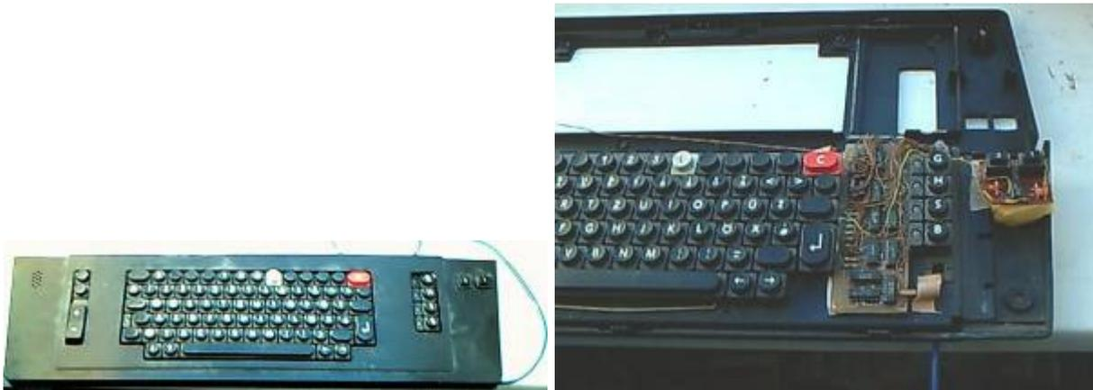
Die Leiterplatte wurde so entworfen, dass sie auf einer K7659-Tastatur rechts zwischen Enter und Sondertasten passt.
