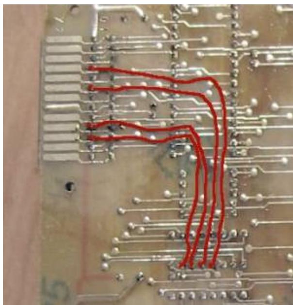
Damit 12 Spalten abgefragt werden koennen, muss die 4-bit Spalteninformation neu decodiert werden, da der originale Spaltendecoder nur bis 10 decodiert. Dazu ist es erforderlich, dass die 4-bit-Spalteninformation vom Spaltenlatch A47 ueber die vier freien Kontakte auf dem Loekamm des Tastaturanschlusses gefuehrt wird. Sollten auch diese vier Draehte zu viel Aenderung auf der Platine darstellen, so kann der Spaltenlatch auch extern ueber den Systemstecker neu ausdecodiert werden.
