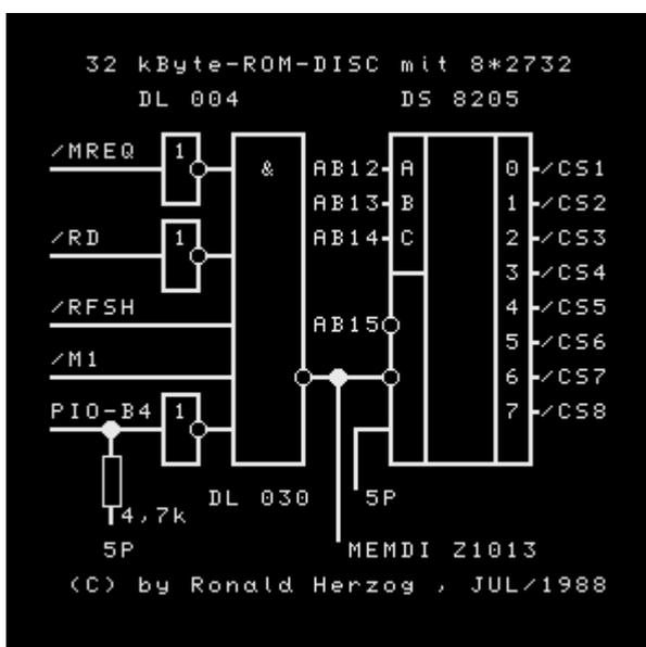
Die Hardware ist kaum noch zu unterbieten. Sie besteht aus 1 DL 004, 1 DL 030, 1 DS 8205. Der Schaltplan ist im File C:\ROM-DISC-BILD dargestellt. Der Aufbau erfolgt auf der „MEM1-Speicherkarte“ aus dem Buch „Praktische Microcomputertechnik“ von [Kramer](#).
