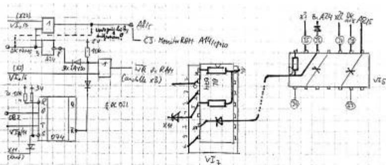
Achtung: vollst. I/O-Dekodierung entfällt! (damit auch x34..x39 in ursprünglicher Bedeutung)
